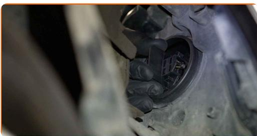
**4** Fjern den gamle pæren. Bruk en flat skrutrekker. Sjekk tilstanden til lyspære sokkelen. Skift ut om nødvendig.
