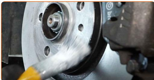
**88** Rengjør overflaten av bremseskiven. Bruk bremserens.
