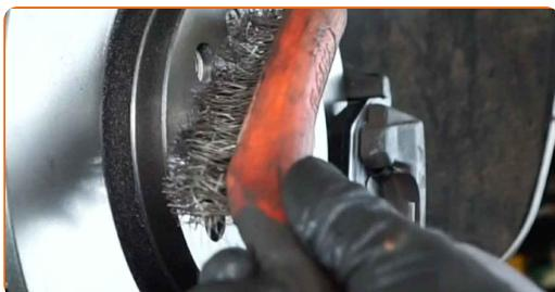
**87** Behandle overflaten hvor bremseskiven kontakter felgen. Bruk keramisk pasta.
