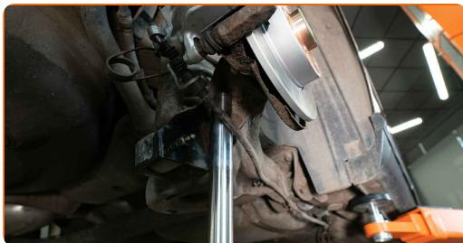
**8** Skru fast det nedre festet på støtdemperen. Bruk en kombinasjonsnøkkel #16. Bruk en pipenøkkelinnsats #16.
