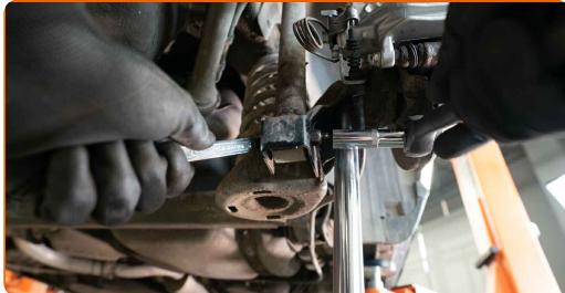
**9** Skru løs støtdemperens øvre feste. Bruk en pipenøkkelinnsats #16.
