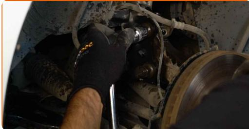
**16** Løft opp styrespindelen. Bruk en hydraulisk jekk.
