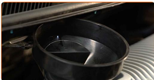
31 Tøm oljen inn i motoren gjennom påfyllingshullet. Nødvendig mengde olje: 4.
