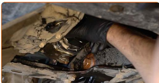
**22** Skru til hetten. Bruk en 67-14F-pipenøkkelinnsats. Bruk en momentnøkkel. Stram den til 25 Nm dreiemoment.
