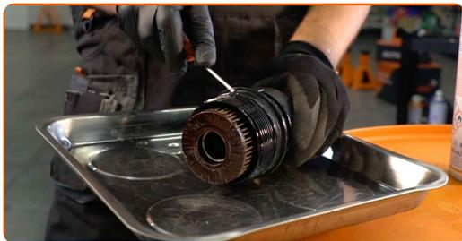
**16** Rengjør lokket til oljefilterhuset. Bruk universal rengjøringspray.
