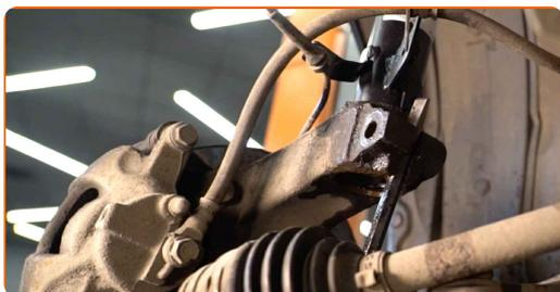
50 Rengjør rillene på CV-leddet til drivakselen. Bruk en stålbørste. Bruk WD-40 spray.
