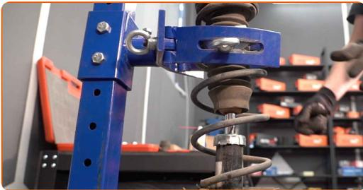
35 Ta av støtdemper-støvhetten og støtstopperen.
