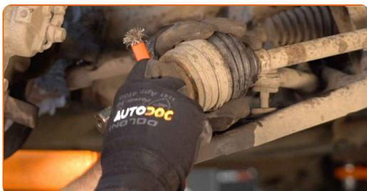
51 Behandle rillene i CV-leddet til drivakselen med et passende middel. Bruk kobberfett.
