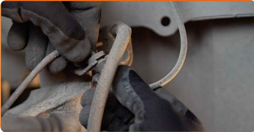
13 Rengjør festene til ABS sensoren og til bremseslangen som kobler de til støtdemperen. Rengjør festene som kobler fjærbein til styrespindel. Bruk en stålbørste. Bruk WD-40 spray.
