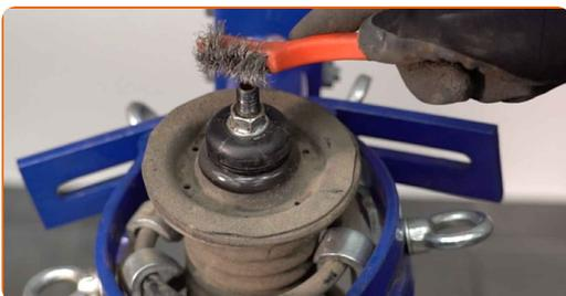
32 Fjern mutteren på beinets stempelstang. Bruk en kombinasjonsnøkkel #17. Bruk XZN #6. Bruk en skrallenøkkel.
