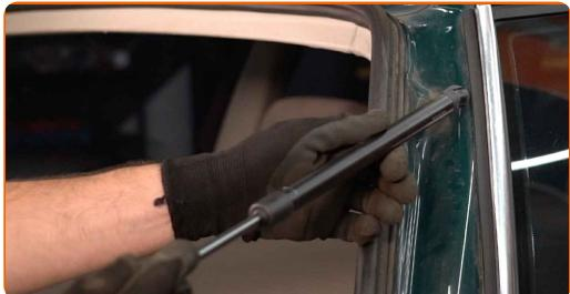
**Utskifting: bakluke demper – VW Passat B5 Variant. AUTODOCs eksperter
