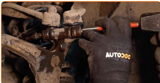
**15** Fjern den øvre bæreammen fra rattspindelen (2 stykker). Bruk et brekkjern.
