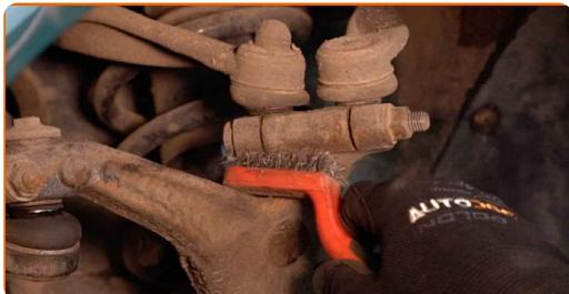
**13** Skru av de øvre kontrollarmfestene (2 stykker). Bruk en kombinasjonsnøkkel #16. Bruk en pipenøkkelinnsats #16.
