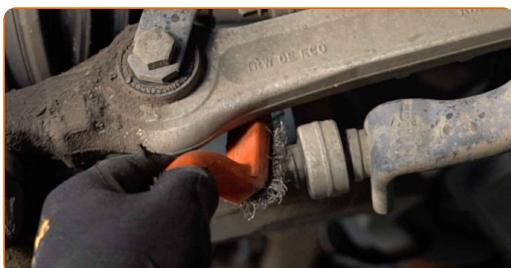
**17** Skru løs festene som kobler stabilisator-ledd til stabilisatorstag. Bruk en kombinasjonsnøkkel #16 (2 stykker).
