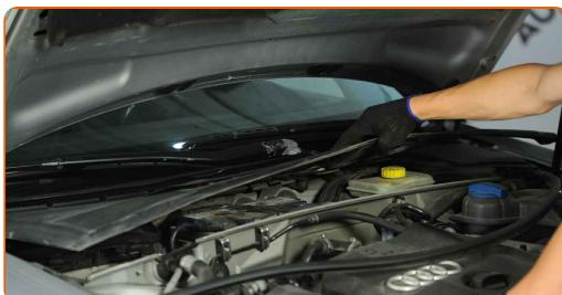
**18** Bytt hetten til monteringen for fjærbeinet. Bruk en flat skrutrekker.
