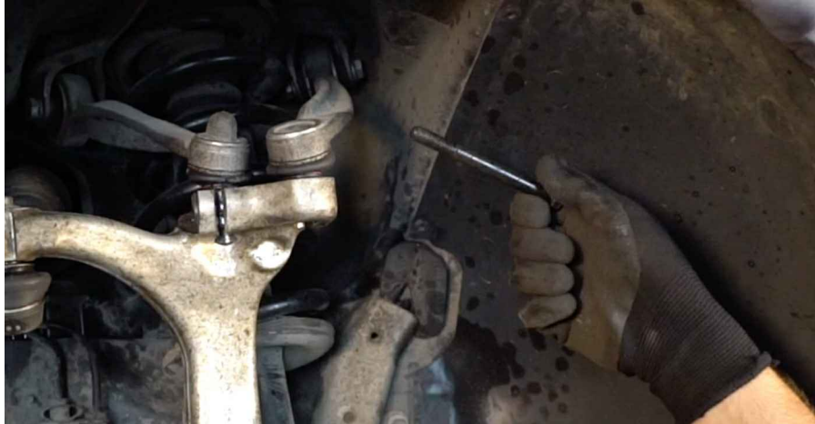
15 Støtt armen. Bruk en hydraulisk jekk.
