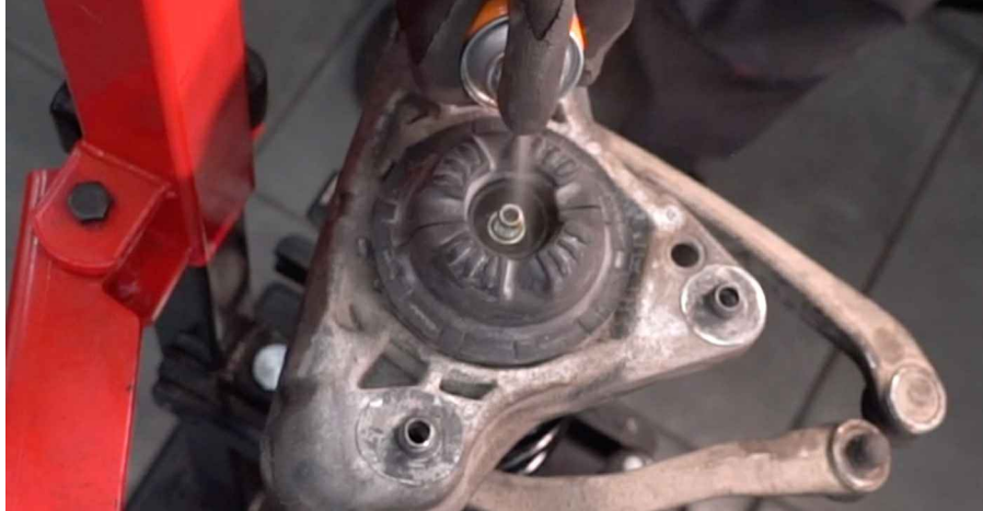
54 Fjern den monterte støtdemperen.
