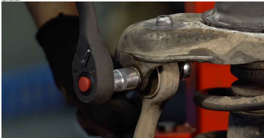
34 Skruløs festene som forbinder bæreamene med festepunktet til fjærbeinet. Bruk en kombinasjonsnøkkel #16. Bruk en pipenøkkelinnsats #16. Bruk en skrallenøkkel.
