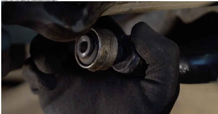
67 Stram festet for stabilisatorlinken.
