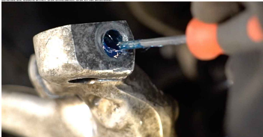
63 Fest den øvre bæreamen til rattspindelen (2 stykker).
