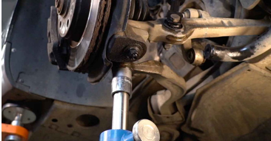
62 Behandle alle leddene armen. Bruk universalfett. Bruk en flat skrutrekker.
