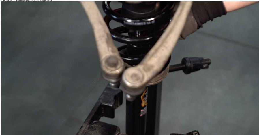
55 Installer fjærbeinet inn i hjulbuen.
