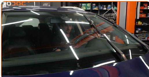
9 Sjekke vindusviskernes ytelse etter installasjonen. Bladene skal ikke overlappe eller bumpe mot frontruten.
