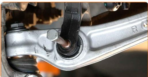
**34** Stram kuleleddfestet. Bruk en pipenøkkelinnsats #18. Bruk en momentnøkkel. Stram den til 110 Nm dreiemoment.
