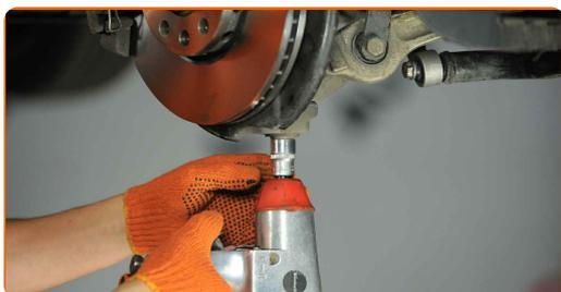
**8** Koble den nedre armen fra styrespindelen. Bruk en avtrekker for kuleledd.
