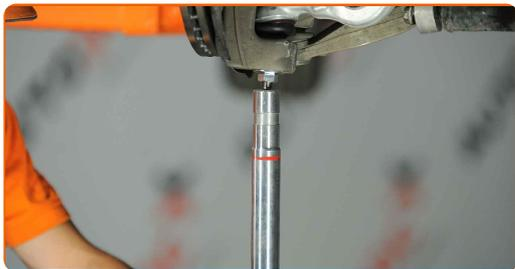
**40** Stram det nedre festet på støtdemperen. Bruk en kombinasjonsnøkkel #18. Bruk en pipenøkkelinnsats #18. Bruk en momentnøkkel. Stram den til 90 Nm dreiemoment.
