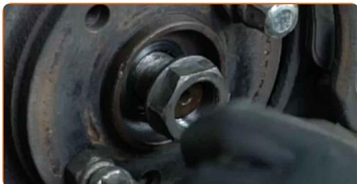
11 Løs drivakselen i hjulnavet. Bruk en spikerdor. Bruk en hammer.
