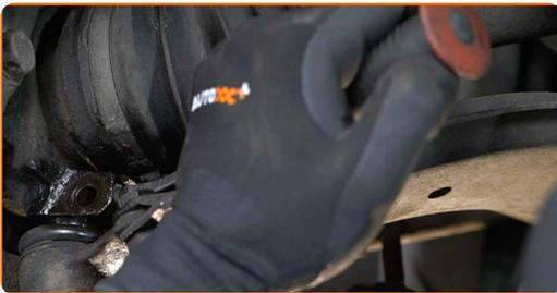
18 Koble kuleleddet fra styrespindelen. Bruk et brekkjern.
