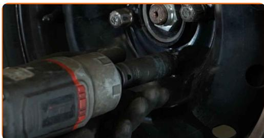
52 Senk bilen og stram hjulboltene, arbeid på kryss. Bruk en kraftpipe for hjulmutter #19. Bruk en momentnøkkel. Stram den til 90 Nm dreiemoment.
