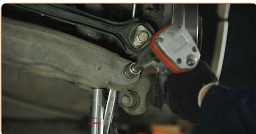
**23** Behandle monteringsstedene til det bakre styreleddet med et passende middel. Bruk kobberfett.
