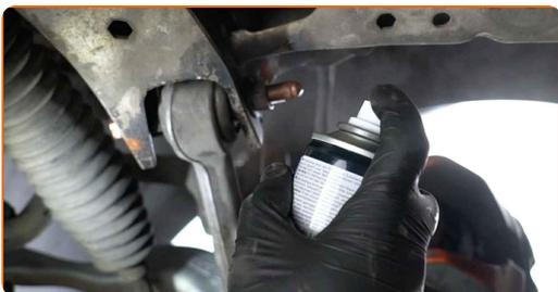
**75** Behandle overflaten hvor bremseskiven kontakter felgen. Bruk kobberfett.
