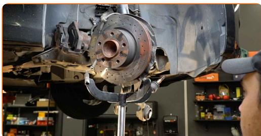
**31** Friggjør nedre feste som kobler fjærbein til styrespindel. Bruk en spesiell pipenøkkel til å fjerne støtdemperen. Bruk en skrallenøkkel.
