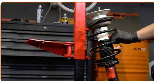
**48** Behandle setet/festepunktet til fjærbeinet på styrespindelen. Bruk en stålbørste. Bruk WD-40 spray.
