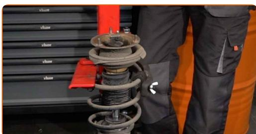
**38** Bytt hetten til monteringen for fjærbeinet. Bruk et brekkjern.
