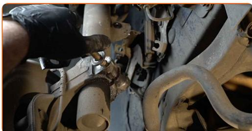
**30** Løft opp styrespindelen. Bruk en hydraulisk jekk.
