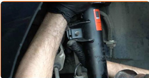
**73** Stram festene som kobler stabilisator-ledd til fjærbein. Bruk en kombinasjonsnøkkel #18. Bruk en pipenøkkelinnsats #15. Bruk en momentnøkkel. Stram den til 58 Nm dreiemoment.
