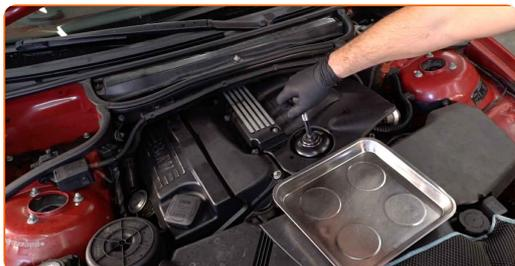
20 Skru til hetten. Bruk en 86/16 F-pipenøkkelinnsats. Bruk en momentnøkkel. Stram den til 25 Nm dreiemoment.
