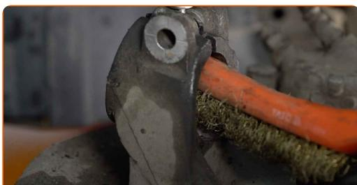
**56** Fest fjærbeinet på styrespindelen. Bruk en flat metal meisel. Bruk en hammer.
