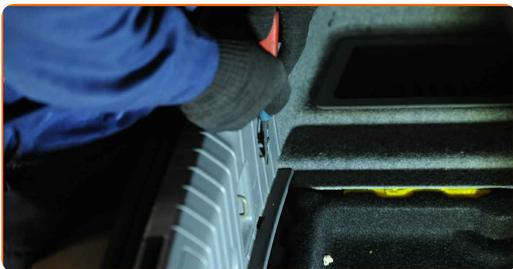
**16** Skru løs festene til bakfanger beskyttelsen av plast. Bruk en Philips-skrutrekker.
