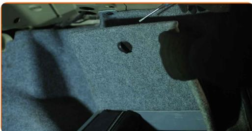
**19** Fjern klipsene til bagasjeromkledningen på siden. Bruk en flat skrutrekker.
