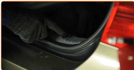
**42** Legg på plass den fremre nedre kledningen til bagasjerommet.
