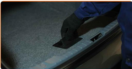
**15** Fjern klipsene fra bakfanger beskyttelsen av plast. Bruk flate skrutrekke (2 stykker).
