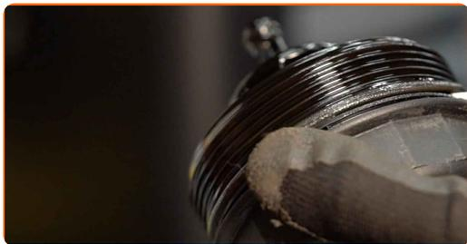
**22** Fjern gammel O-ringe fra dekselet til oljefilteret. Bruk en flat skrutrekker.
