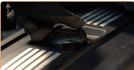
4 Skru løs filterhushetten sammen med det gamle filterelementet. Bruk en 86-16F-pipenøkkelinnsats. Bruk en skrallenøkkel.
