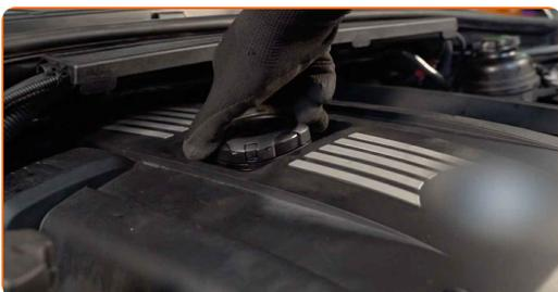
**33** Kjør motoren i noen minutter. Etter at varsellampen for oljetrykk slukkes, stopp motoren.
