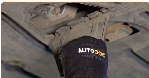
**12** Plasser en beholder for avfallsolje, med minst 7 l. kapasitet, under dreneringshullet.
