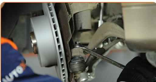
**12** Koble strekkstangenden fra styrespindelen.
