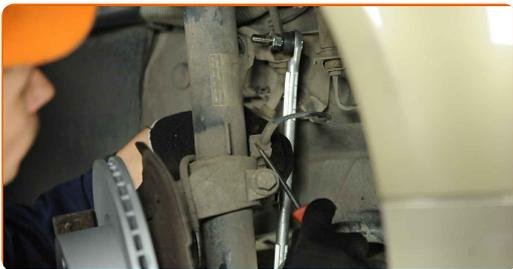
**10** Rens festene som kobler endeledet til rattspindelen. Bruk en stålbørste. Bruk WD-40 spray.
