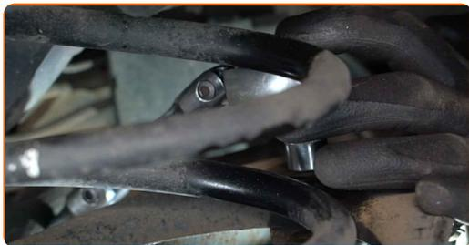
**26** Støtt armen. Bruk en hydraulisk jekk.
