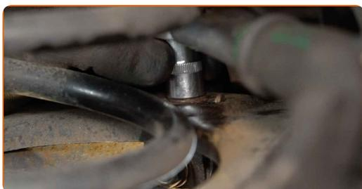
**28** Stram festet til stabilisatorstagbraketten. Bruk en kombinasjonsnøkkel #13. Bruk en pipenøkkelinnsats #13. Bruk en momentnøkkel. Stram den til 25 Nm dreiemoment.
