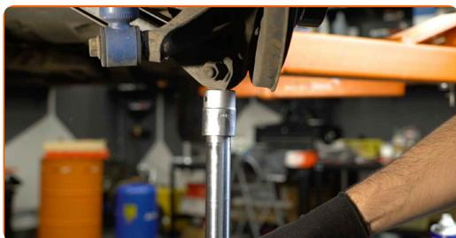
**27** Stram festet som forbinder stabilisatorstaget med bæreamen. Bruk en pipenøkkelinnsats #13. Bruk en momentnøkkel. Stram den til 27 Nm dreiemoment.
