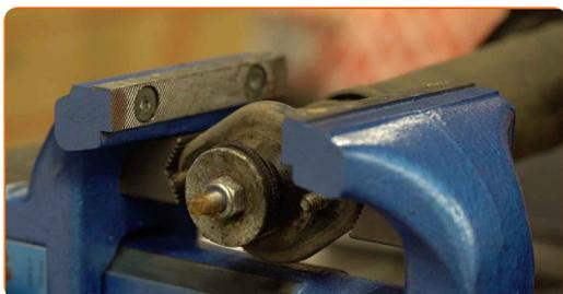
**17** Rengjør festene til støtdemperstangen. Bruk en stålbørste.
