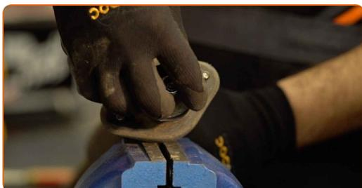
**20** Fjern støtdemperfestet, støvbeskytteren og støtstopperen.
