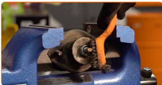
**18** Fjern støtdemperen stempelstangen feste. Bruk en kombinasjonsnøkkel #17.
