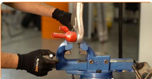
**23** Behandle montasjeflaten til bæream foringen. Bruk WD-40 spray.
