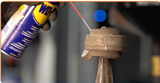
**20** Fjern bæream foringen. Bruk 3-Arm Gear Puller (avtrekker med tre klør for tannhjul).
