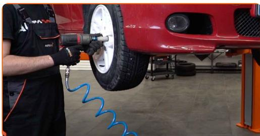
**47** Senk bilen og stram hjulboltene, arbeid på kryss. Bruk en momentnøkkel. Stram den til 120 Nm dreiemoment.
