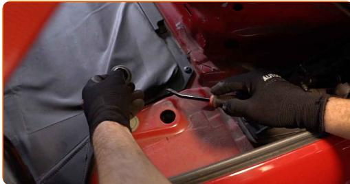
**3** Rengjør festene til støtdempernes øvre montering. Bruk WD-40 spray.
