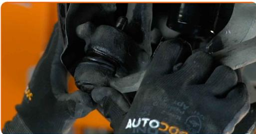
**69** Skru på festemutteren som kobler endeledet til rattspindelen. Bruk en kombinasjonsnøkkel #18.
