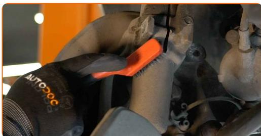
**35** Frigjør nedre feste som kobler fjærbein til styrespindel. Bruk en spesiell pipenøkkel til å fjerne støtdemperen.
