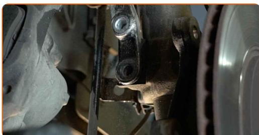
**19** Rens festene som kobler endeledet til rattspindelen. Bruk en stålbørste. Bruk WD-40 spray.
