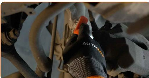
**12** Rengjør festene på braketten til bremsecaliperen. Bruk en stålbørste. Bruk WD-40 spray.
