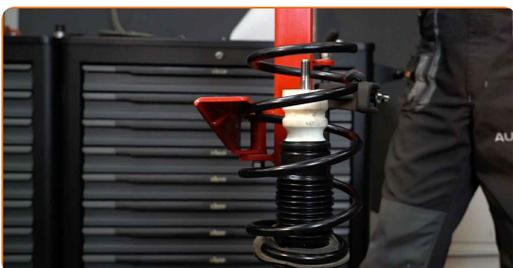
**52** Installer den øvre demperen og monteringslager.
