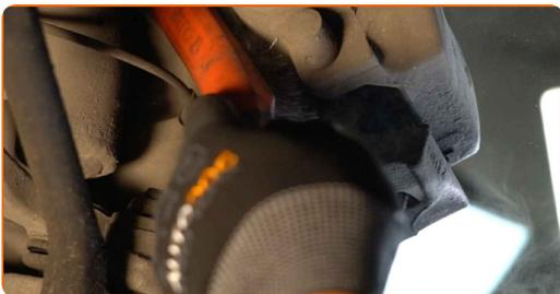
**13** Spre bremseklossene. Bruk et brekkjern.
