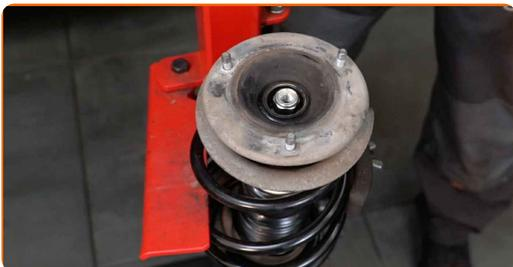
**53** Stram fjærbeinets stempelstangmutter. Bruk en pipenøkkelinnsats #22. Bruk HEX nr. H6. Bruk en momentnøkkel. Stram den til 64 Nm dreiemoment.
