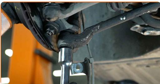
**68** Koble strekkstangenden til styrespindelen.
