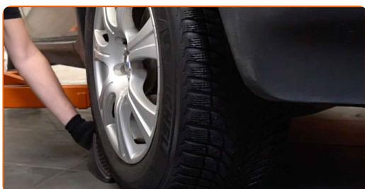
6 Løsne hjulfesteboltene. Bruk en kraftpipe for hjulmutter #19.
