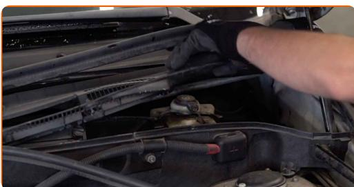
4 Skru løs tanklokket for bremsevæsken.
