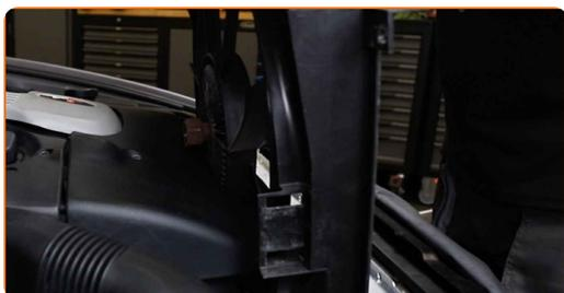
**26** Stram løs festet til kjøleviften. Bruk en kombinasjonsnøkkel #32 (2 stykker). Bruk en momentnøkkel. Stram den til 33 Nm dreiemoment.
