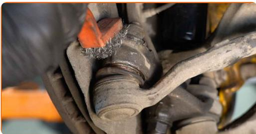
**9** Skru endefestemutteren fast til styrespindelen. Bruk en pipenøkkelinnsats #21. Bruk en skrallenøkkel.
