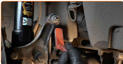
**7** Skru løs festene som kobler stabilisator-ledd til fjærbein. Bruk en pipenøkkelinnsats #16. Bruk en skrallenøkkel.
