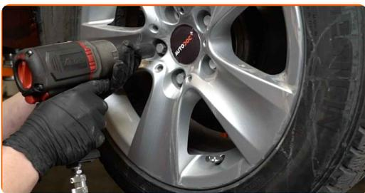
**64** Senk bilen og stram hjulboltene, arbeid på kryss. Bruk en kraftpipe for hjulmutter #17. Bruk en momentnøkkel. Stram den til 120 Nm dreiemoment.
