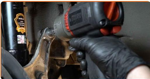
**8** Rens festene som kobler endeledet til rattspindelen. Bruk en stålbørste. Bruk WD-40 spray.
