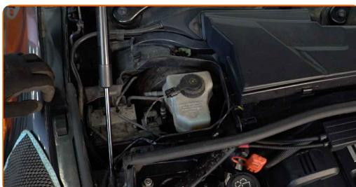
**4** Skru løs tanklokket for bremsevæsken.
