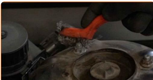
**5** Løsne det øvre festet til fjærbeinet. Bruk en pipenøkkelinnsats #13. Bruk en skrallenøkkel.
