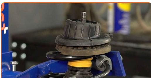
**30** Stram fjærbeinets stempelstangmutter. Bruk en kombinasjonsnøkkel #19. Bruk HEX nr. H6. Bruk en momentnøkkel. Stram den til 60 Nm dreiemoment.
