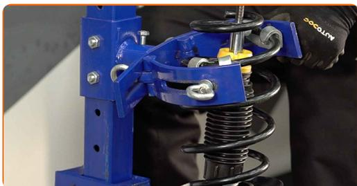
**29** Installer den øvre demperen og monteringslager.
