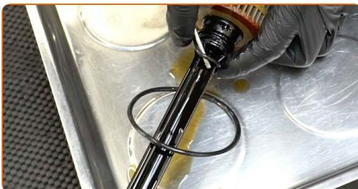
**18** Rengjør lokket til oljefilterhuset. Bruk universal rengjøringsspray.
