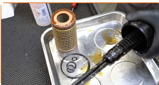
**17** Fjern gammel O-ring fra dekselet til oljefilteret. Bruk en flat skrutrekker.
