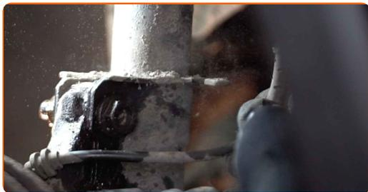
**16** Skru løs nedre feste som kobler fjærbein til styrespindel. Bruk en kombinasjonsnøkkel #18. Bruk en pipenøkkelinnsats #18. Bruk et svingjern.
