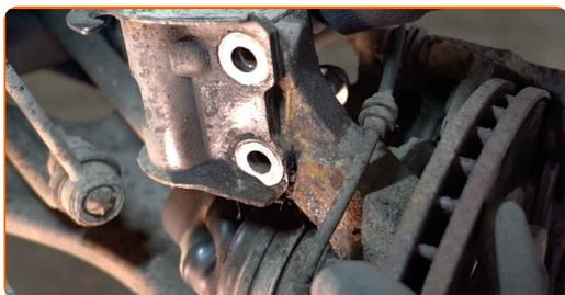
20 Koble styrespindelen fra fjærbeinet. Bruk et brekkjern.
