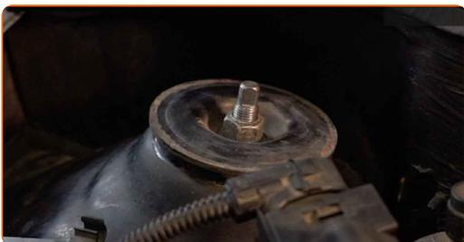
**4** Behandle stangen til fjærbeinet. Bruk en stålbørste. Bruk WD-40 spray.
