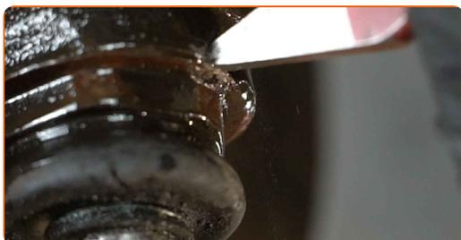
**19** Skru kuleleddfestet til styrespindelen. Bruk en pipenøkkelinnsats #41. Bruk en skrallenøkkel.
