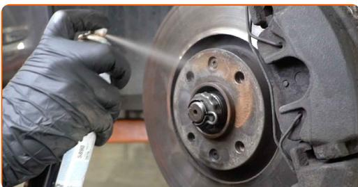
**43** Rengjør overflaten av bremseskiven. Bruk bremsrens.
