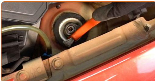
**4** Løsne det øverste festet på fjærbeinets montering. Bruk HEX nr. H7. Bruk en kombinasjonsnøkkel #22. Bruk en skrallenøkkel.
