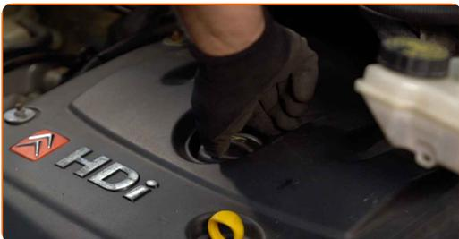
23 Kjør motoren i noen minutter. Etter at varsellampen for oljetrykk slukkes, stopp motoren.
