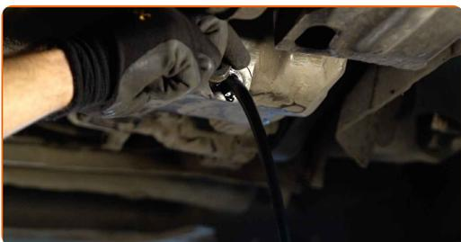
Utskifting: motorolje og oljefilter – CITROËN C3 Aircross II (2R\_, 2C\_).
