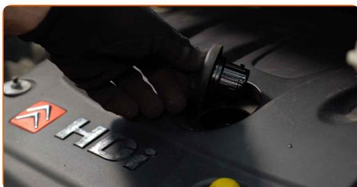
**4** Skru løs oljefilteret. Bruk en 74/76-15F-pipenøkkelinnsats.
