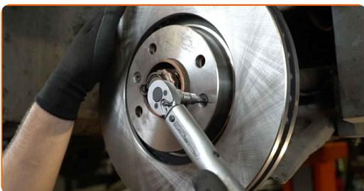
**21** Rengjør overflaten av bremseskiven. Bruk bremsrens.
