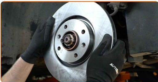
**20** Stram bremseskivefestet. Bruk Torx T30. Bruk en momentnøkkel. Stram den til 9 Nm dreiemoment.
