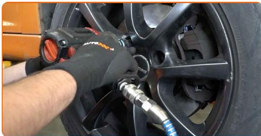
**34** Senk bilen og stram hjulboltene, arbeid på kryss. Bruk en kraftpipe for hjulmutter #17. Bruk en momentnøkkel. Stram den til 100 Nm dreiemoment.
