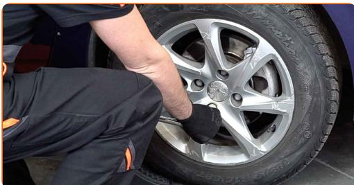
**3** Løsne festet til drivakselen. Bruk en pipenøkkelinnsats #32. Bruk et svingjern.
