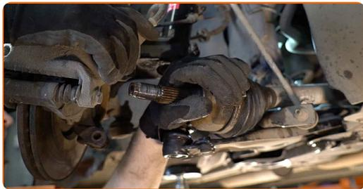
**17** Skru løs festet til den fremre armen. Bruk Torx T55. Bruk en pipenøkkelinnsats #18. Bruk en skrallenøkkel.
