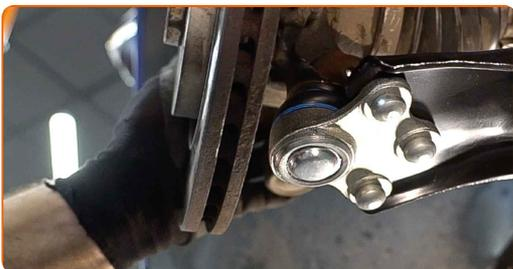
**26** Støtt armen. Bruk en hydraulisk jekk.
