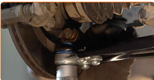
**28** Skru fast festet som kobler kulleleddet til styrespindelen. Bruk en pipenøkkelinnsats #16. Bruk en pipenøkkelinnsats #E8. Bruk en skrallenøkkel.
