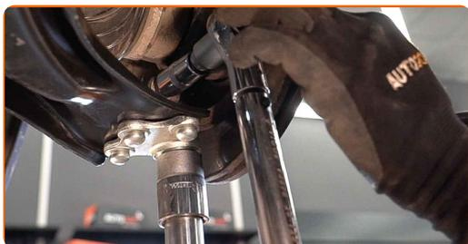
**32** Stram festene som kobler kontrollarmen til underrammen. Bruk en pipenøkkelinnsats #18. Bruk en momentnøkkel. Stram den til 120 Nm dreiemoment.
