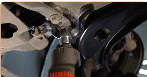
**31** Stram kuleleddfestet. Bruk en pipenøkkelinnsats #16. Bruk en momentnøkkel. Stram den til 40 Nm dreiemoment.
