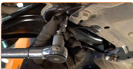
**33** Stram det bakre festet til bæreammen. Bruk en pipenøkkelinnsats #18. Bruk en momentnøkkel. Stram den til 120 Nm dreiemoment.
