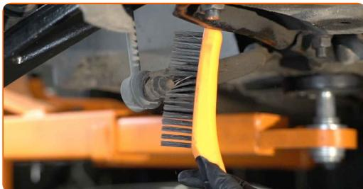
10 Skru løs festene som kobler stabilisator-ledd til stabilisatorstag. Bruk en kombinasjonsnøkkel #16. Bruk en pipenøkkelinnsats #15. Bruk en skrallenøkkel.
