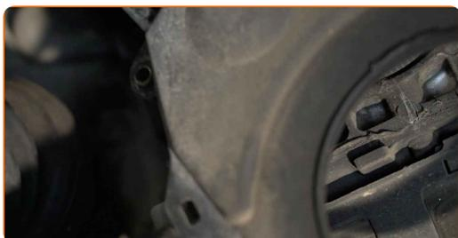
**46** Fjern låseverktøyet for veivakseltannhjulet. Bruk en universell avtrekker.
