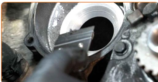
**66** Rengjør vannpumpen. Bruk universal rengjøringspray.
