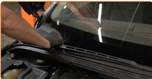
**7** Fjern klemmene fra plastgrillen på panseret. Bruk et demonteringsverktøy for klemmer.
