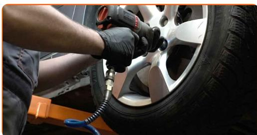
**130** Senk bilen og stram hjulboltene, arbeid på kryss. Bruk en kraftpipe for hjulmutter #17. Bruk en momentnøkkel. Stram den til 100 Nm dreiemoment.
