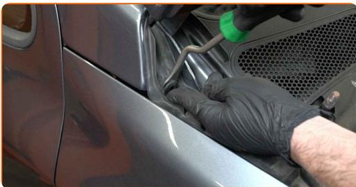
**8** Skru løs festene på bremsevæskebeholderen. Bruk Torx T20. Bruk en skrallenøkkel.
