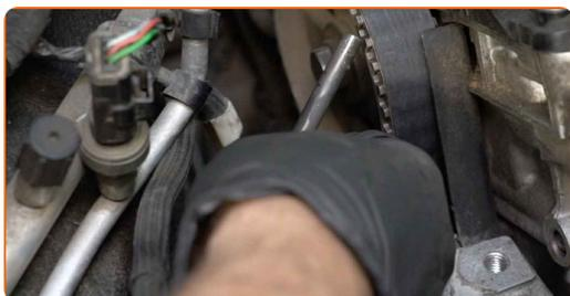
**86** Skru inn festet til veivakselhjulet. Bruk en pipenøkkelinnsats #22. Bruk en skrallenøkkel.
