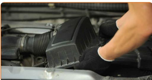
**5** Fjern filterelementet fra filterhuset.
