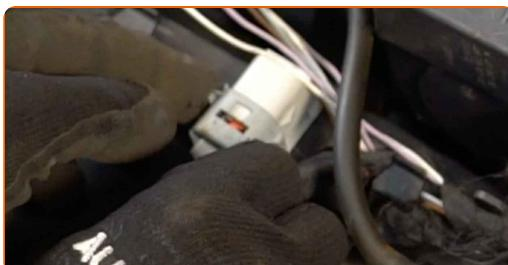
**28** Koble slangen til veivhusventilasjonen til luftkanalen.
