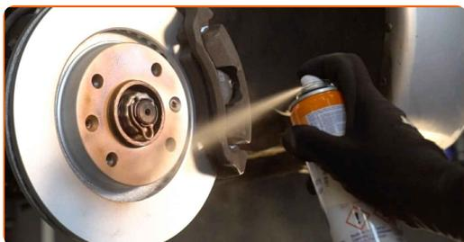
**32** Rengjør overflaten av bremseskiven. Bruk bremsrens.
