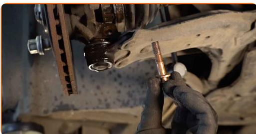
**9** Koble den nedre armen fra styrespindelen. Bruk et brekkjern.
