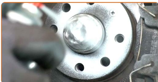
**48** Rengjør overflaten av bremseskiven. Bruk bremsrens.
