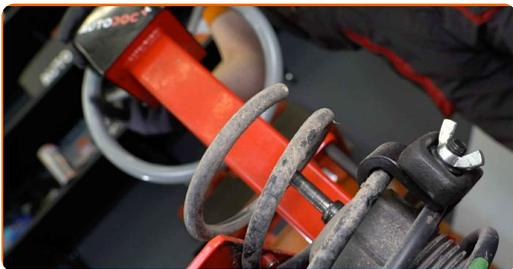
25 Ta av støtdemper-støvhetten og støtstopperen.
