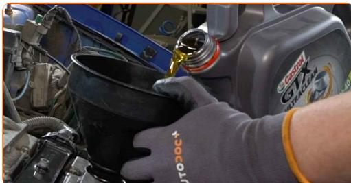
**Utskifting: motorolje og oljefilter – Opel Corsa S93. AUTODOCs eksperter
