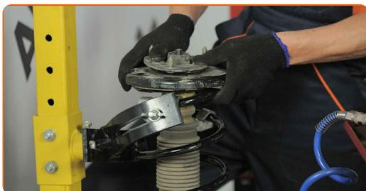
**34** Stram fjærbeinets stempelstangmutter. Bruk en kombinasjonsnøkkel #19. Bruk HEX nr. H7. Bruk en momentnøkkel. Stram den til 44 Nm dreiemoment.
