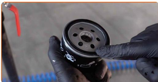
**14** Skru det nye filteret på plass. Bruk en 76/14-F-pipenøkkelinnsats. Bruk en momentnøkkel. Stram den til 21 Nm dreiemoment.
