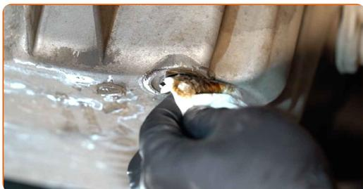
**16** Skru inn den nye dreneringspluggen og stram den. Bruk en firkantnøkkel for oljetappeplugg nr.8. Bruk en momentnøkkel. Stram den til 20 Nm dreiemoment.
