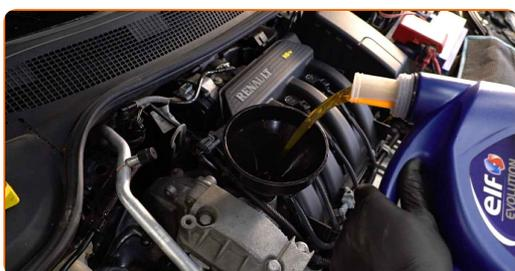
Utskifting: motorolje og oljefilter – DACIA SUPERNOVA. Tips:
