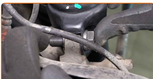
**40** Stram de nedre festene på støtdemperne. Bruk en pipenøkkelinnsats #19. Bruk en momentnøkkel. Stram den til 110 Nm dreiemoment.
