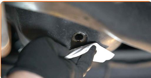
**6** Skru inn den nye dreneringspluggen og stram den. Bruk en pipenøkkelinnsats #13. Bruk en momentnøkkel. Stram den til 28 Nm dreiemoment.
