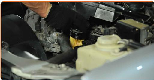
**20.2** Bruk en flat skrutrekker. Bruk en 65/14F-pipenøkkelinnsats. Bruk en momentnøkkel. Stram den til 25 Nm dreiemoment.
